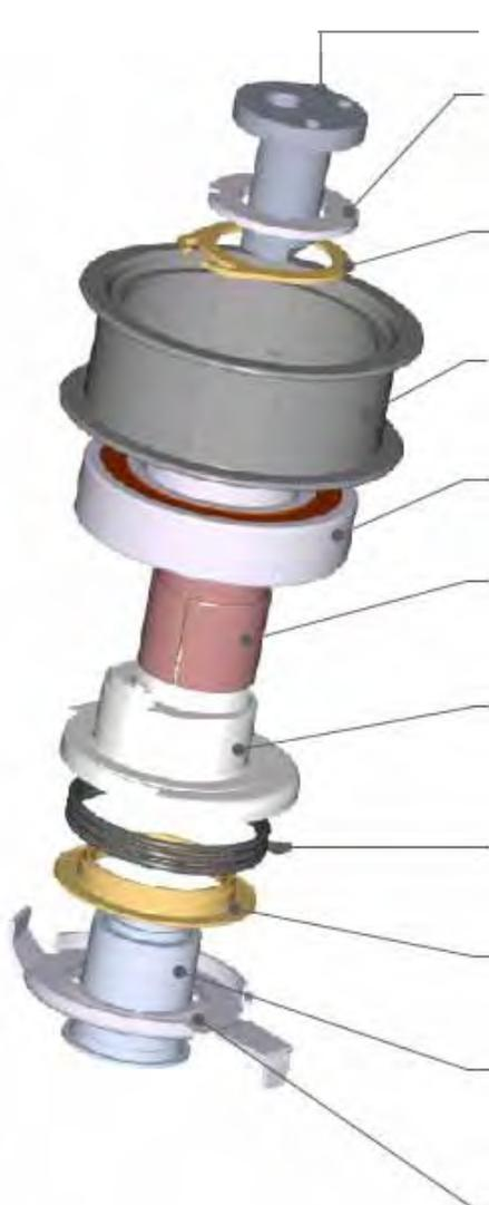
**Eje de instalación:** Asegura que el tensor esté colocado en la posición apropiada del motor cuando está instalado.
