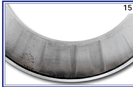
Desgaste ondeado- Desgaste irregular causado por juego lateral excesivo. (15)
