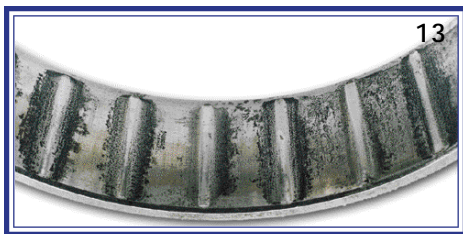
Desgaste causado por la vibración o movimiento lateral relativo entre los rodillos y pistas. (13)
