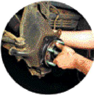
1. Inserta el ensamble de maza nuevo dentro del manguito de dirección. Revisa la posición de las ranuras longitudinales en la flecha del eje mientras insertas la maza.
