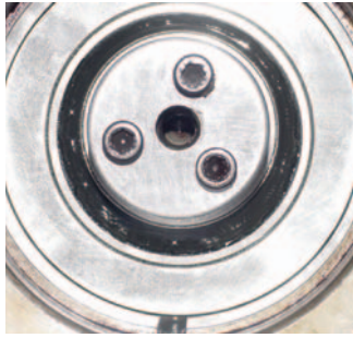
Fig. 1- La grasa "limpia" que escurre ligeramente de un rodamiento al iniciar la operación es generalmente aceptable. La grasa está húmeda y escurre parejo. Si este ligero escurrimiento no causa ningún problema, déjalo así ya que funciona como barrera anticontaminante.
