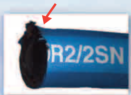
Corte incorrecto por cuchilla mal afilada
