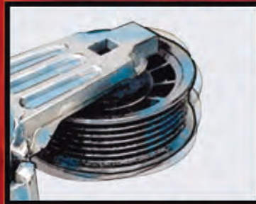
DESGASTE DE LA POLEA
