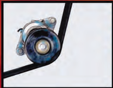
OSCILACIÓN EXCESIVA DEL BRAZO DEL TENSOR
