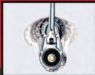
MOVIMIENTO RÍGIDO O CHIRRIANTE DEL BRAZO
