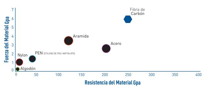
Con la banda Poly Chain® GT® Carbon™ estamos cubriendo requerimientos de la FDA (Food and Drugs Administration) para la regulación de procesos de manufactura de productos para el consumo humano. La banda Poly Chain® GT® Carbon™, se construye con compuestos poliméricos resistentes a productos químicos; con una cuerda de fibra de carbón patentada, que ofrece mayor resistencia y fuerza del material sin perder su flexibilidad.
