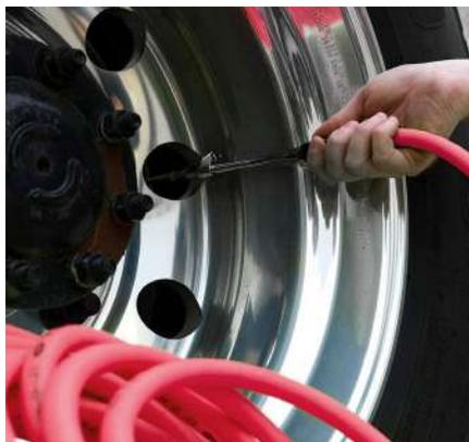
Como recomendación, la mayoría de los operadores utilizan rollos de manguera con longitudes de 50 pies, con el objetivo de llegar hasta la parte trasera de los ejes de la unidad de arrastre y poder hacer un llenado óptimo en cada uno de los neumáticos del remolque, plataforma o pipa.
