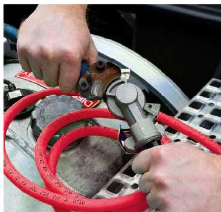
El inflador doble (108) se conecta a la válvula de la llanta, lo que permite el ingreso de aire al neumático.
