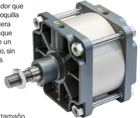
Este actuador pertenece a la familia de los compactos, que le dan el tamaño adecuado para ser sujetado por el equipo. Además, posee un barreno pasado por el vástago para poder ejercer presión de vacío y sujetar el saco a través de ventosas, o en su defecto, aditamentos de goma, que impiden que el saco quede fuera de la posición de llenado.
