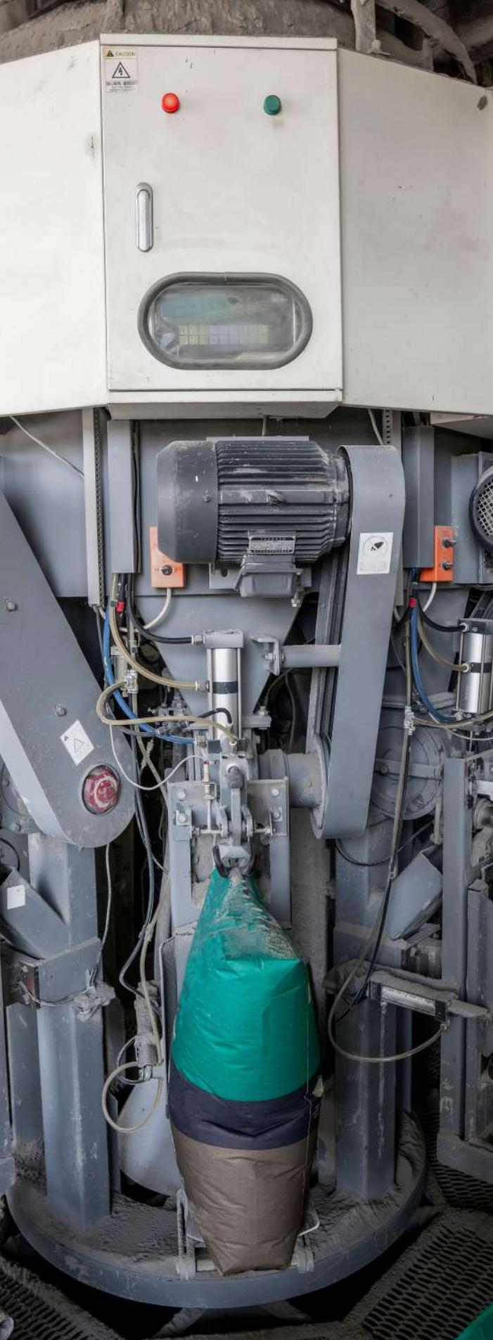
Dentro del proceso de envasado se encuentran diversos actuadores neumáticos especiales, destacando, el pequeño actuador que pisa los sacos e impide que la boquilla de llenado vacíe el cemento fuera de ellos. Estos elementos, aunque de cortas dimensiones, juegan un papel fundamental en el proceso, sin embargo, poseen características específicas para desempeñar su trabajo.
