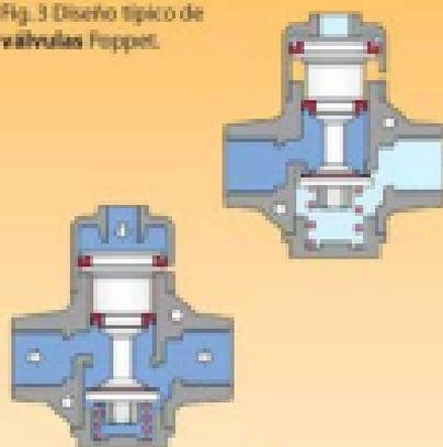
Las **válvulas Poppet** (Fig. 3) utilizan un sello grande de tipo capuchón y que opera de forma similar al de una llave de agua doméstica. La superficie de sello se mueve de forma perpendicular al área de la **válvula** y empuja esta superficie contra un borde o cresta anular, para crear un sellado positivo. Las **válvulas** de asiento son robustas, tienen un funcionamiento rápido y son conocidas por su capacidad de operar en condiciones adversas.
