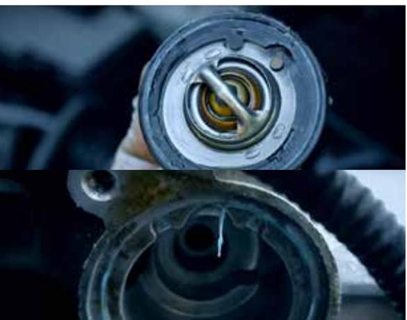
Antes de instalar el nuevo termostato, revisa el resto de los componentes del sistema de enfriamiento: mangueras de refrigerante, bomba de agua y tapón(es) de presión.
