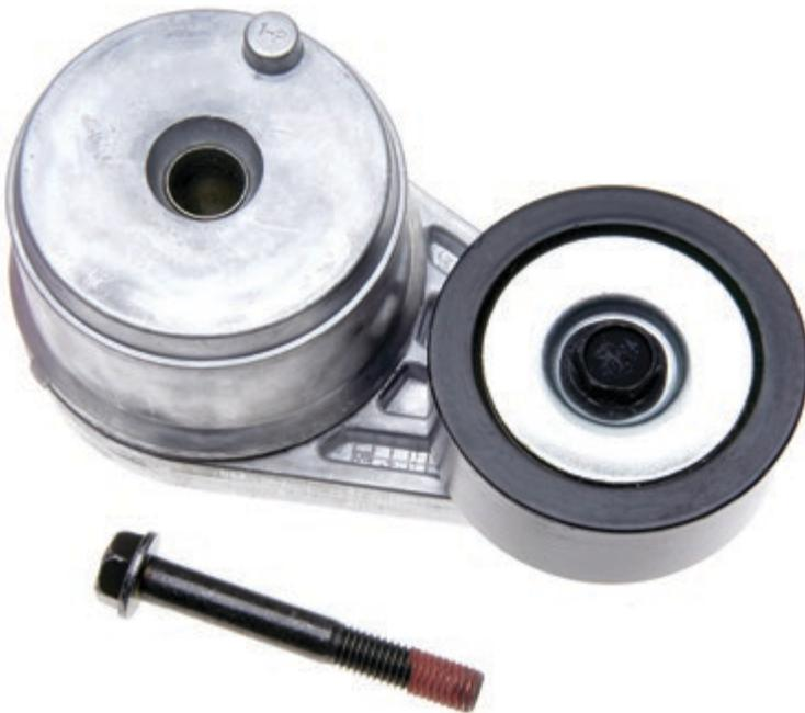
Un tensor de banda sirve para mantener ajustada la banda, de esta manera transmite el movimiento del cigüeñal a los demás componentes, el tensor evita que se salga de las poleas y así asegurar un óptimo desempeño de todos los componentes.
