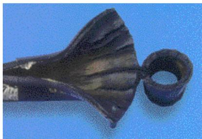
Los ingenieros de Gates fueron los primeros en descubrir que un ataque electroquímico al hule de la manguera era la principal causa de falla de las mangueras de radiador (degradación electroquímica o ECD), y mejor aún resolvieron el problema diseñando hules resistentes al ECD.
