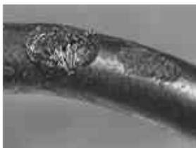
el ataque de sustancias dejando expuesto el refuerzo, el cual es susceptible a la oxidación. Para evitar lo anterior, instálalas fuera del alcance de partes cortantes o protégelas con guardas especiales.
