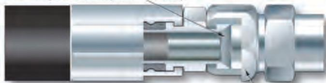
Hasta una presión de ruptura de 24,000 psi (tamaño 16, G6K)
