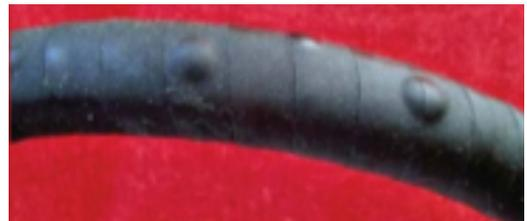
*Cuando la cubierta muestra ampollas, es porque el fluido conducido es incompatible con la manguera.*
