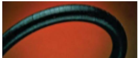
*Mangueras que exceden su radio mínimo de curvatura, producen turbulencias y agrietamiento en la manguera.*
