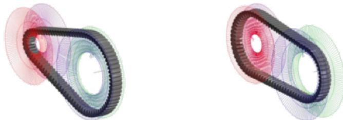
Al estar "abierto" la polea-clutch se instala la banda y finalmente se aprieta.
