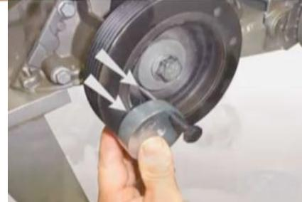
**5** Con la ayuda de una matraca, gira la polea que tiene la herramienta hasta que la banda quede totalmente montada.
