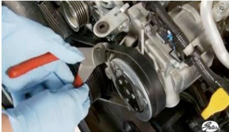
**4** Coloque un extremo de la banda sobre una polea y el otro extremo sobre la herramienta.
