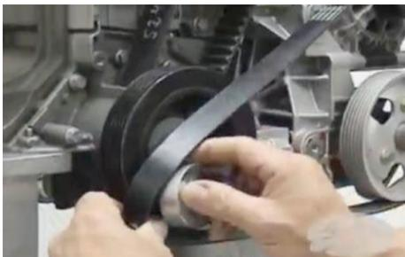
**3** Coloque la herramienta SF en el extremo de una polea y ajústela con el tornillo incluido. Asegúrese que quede bien alineada con la polea.
