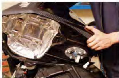
2. Retire los tornillos que fijan el tanque de combustible y enseguida desconecte el arnés eléctrico del control de la bomba y la línea de suministro de combustible. Retire el tanque.
