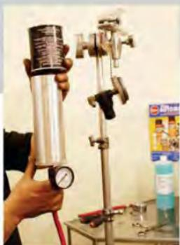
3. Coloque el kit de lavado en un atril elevado, retire la tapa de la boya y vierta el líquido limpiador de inyectores, aproximadamente medio litro
