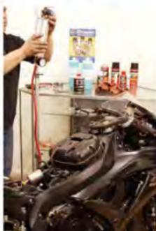
5. Conecte la toma de aire de la compresora en la conexión superior de la boya y regule la presión a un nivel no mayor a 50 psi. Ajustada la presión coloque el seguro de la válvula. Encienda el motor y deje consumir todo el líquido. Al finalizar apague el motor, con lo que el lavado habrá finalizado.
