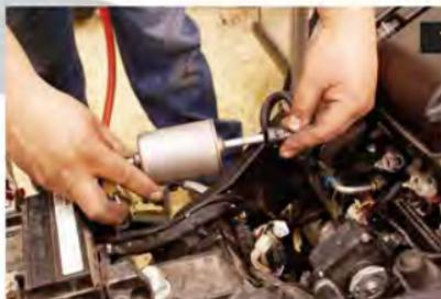
4. La salida del filtro se conecta hacia el conector del riel de inyectores, en el motor de la motocicleta.
